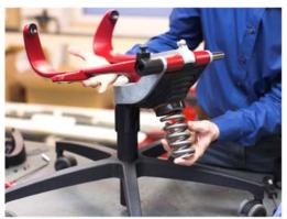
ON のスプリング(写真左)と IN のスプ リング(写真右)。IN では たった 1 本 のばねで、トリメンションの動きをコントロ ールする。
