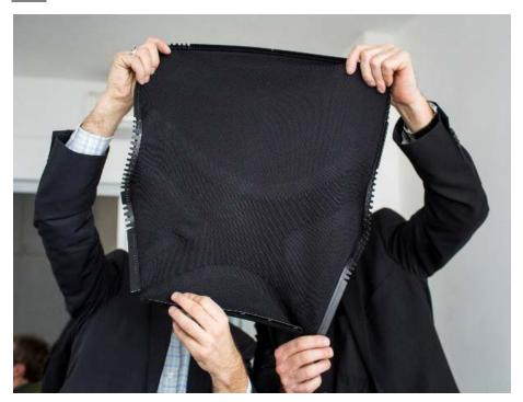
背中の部位それぞれに最適なサポート を提供する、場所によって異なる密度で 織られた3D メッシュ。この 後水に濡らし、 面積を広げて張り作業を行い、乾かしてフ レームにフィットさせる。
